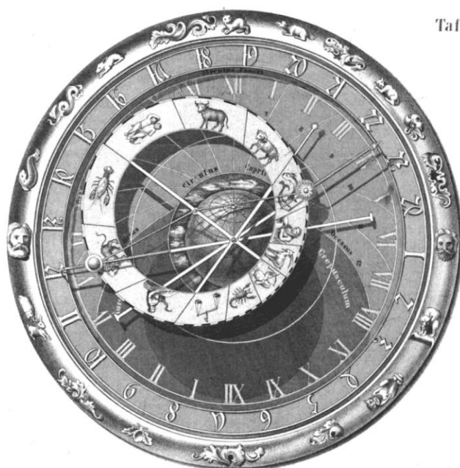
Obr. 20. Kresebný návrh podoby orloje (Böhm 1866). Konstrukce kružnic zde teoreticky odpovídá nesprávnému sklonu zemské osy k rovině ekliptiky 25,5^\circ namísto správné hodnoty 23,5^\circ , stejně jako na astrolábové desce Pražského orloje. Ostře ohraničený kruh temné noci zde přibližně pouze ve své spodní části odpovídá noci astronomické.
