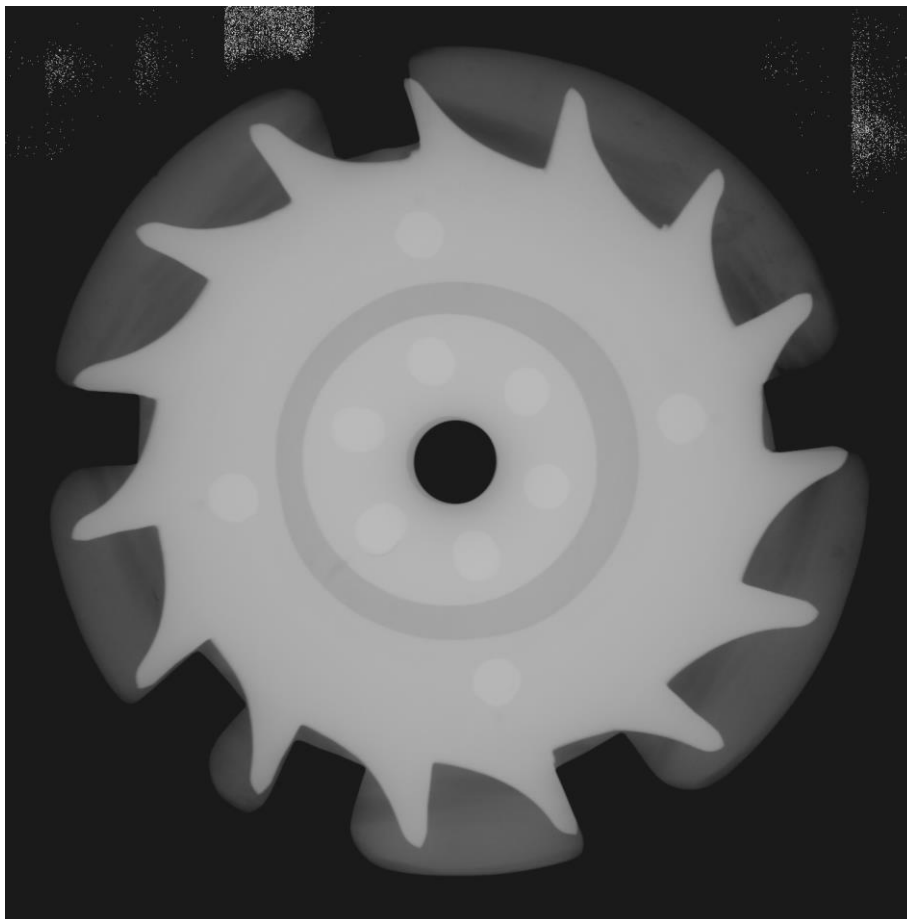
Rentgenový snímek malého závěrkového kolečka
