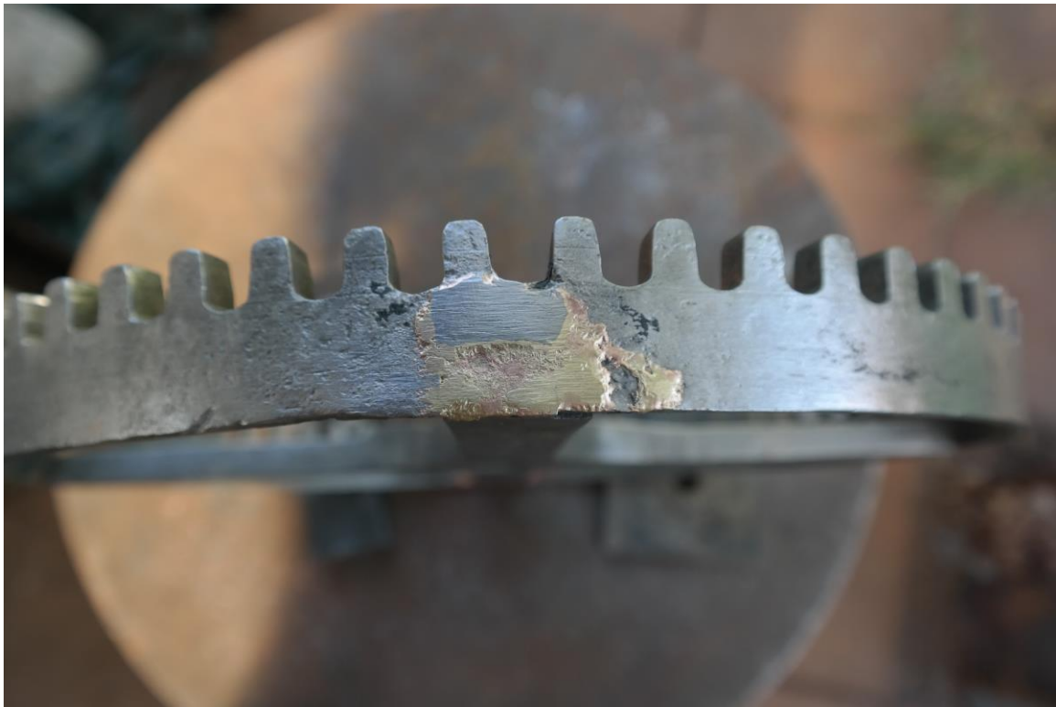
Poválečné sváry a spoje letované mosazí na paprscích kol
