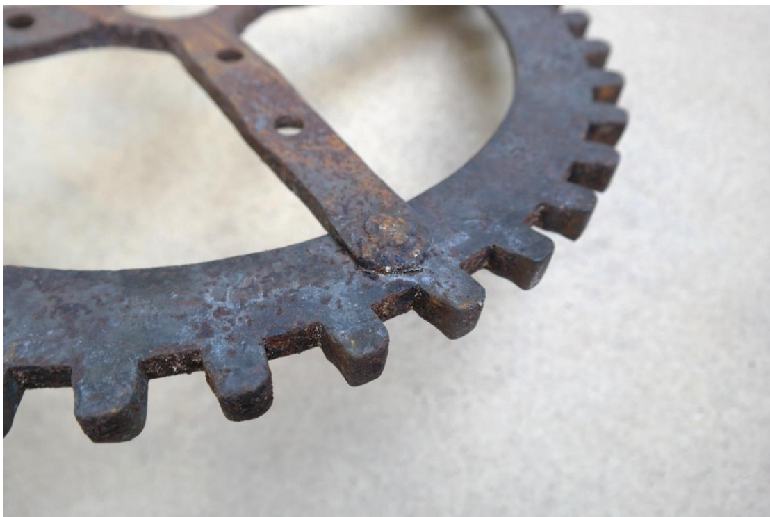
Detail silné vrstvy okují z požáru orloje v roce 1945
