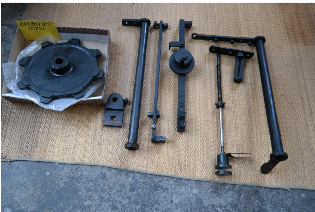
Řetězové kolo apoštolského stroje a díly vypouštěcího mechanismu
