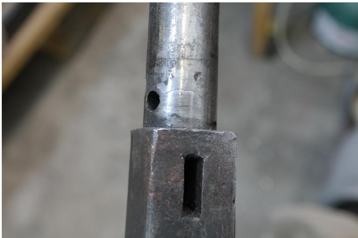
Dole detail praskliny hřídele kalendářního kola
