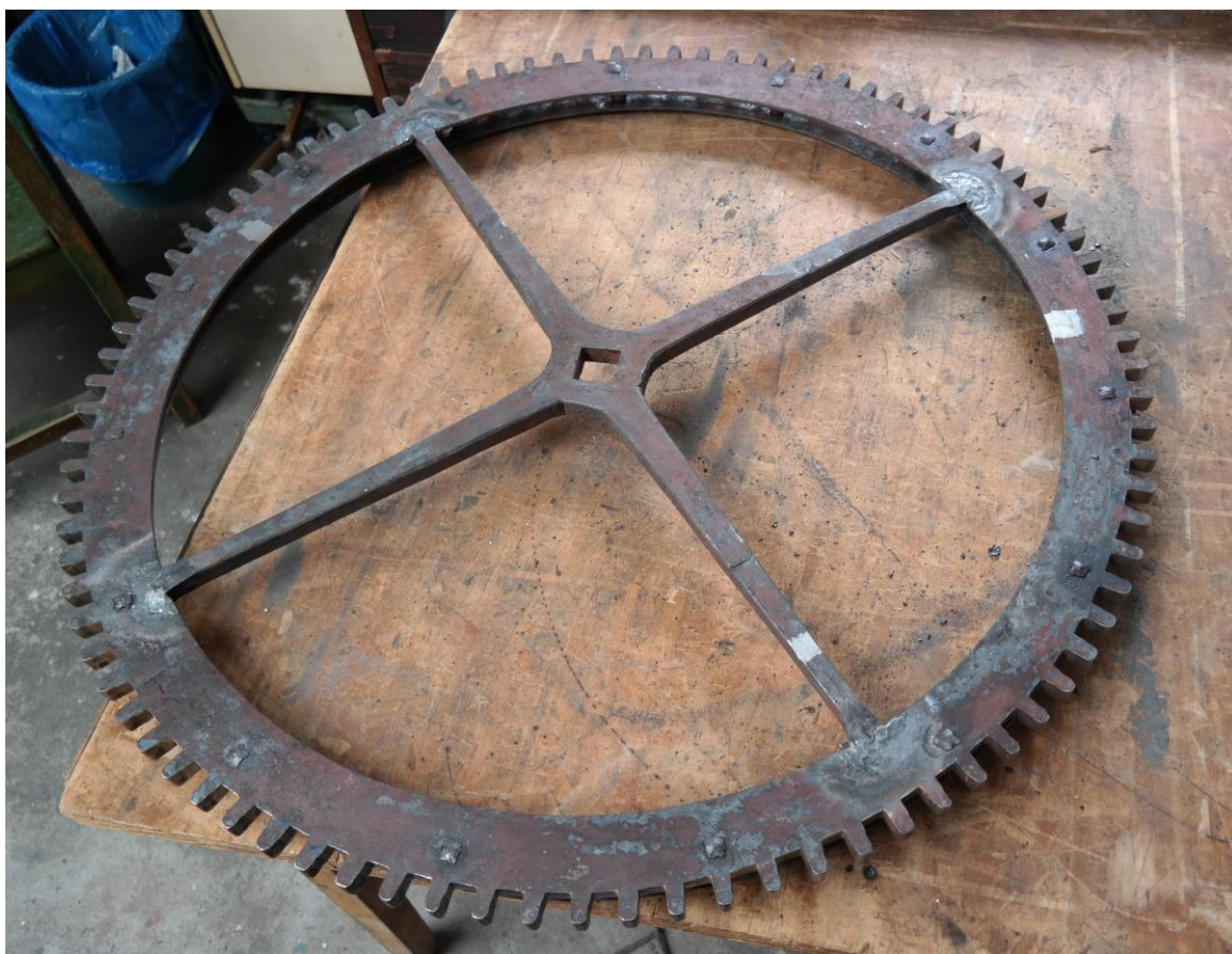
Poválečné sváry a spoje letované mosazí na paprscích kol
