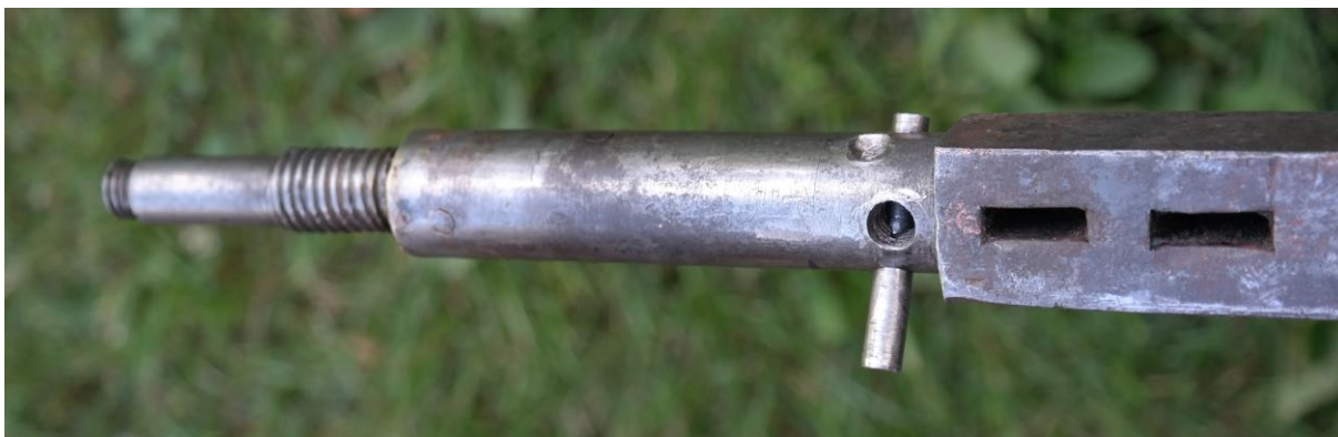
Hřídel kalendářního kola délkově nastavená pravděpodobně v roce 1865 a rentgenové snímky hřídele a vačky mezilehlého kola bicího stroje
