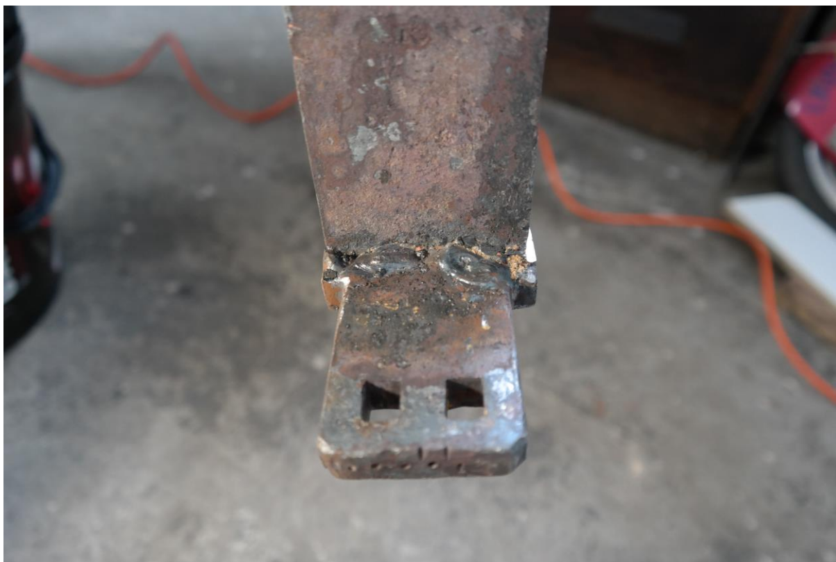
Poválečné sváry na rámu stroje před a po zaretušování
