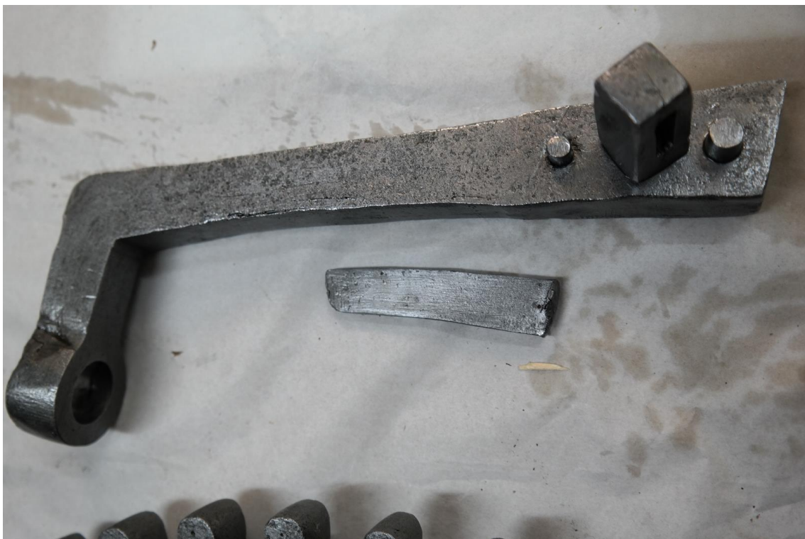
Očištěná ložisková plotna s ložiskem hřídele natahovacího pastorku a klínkem
