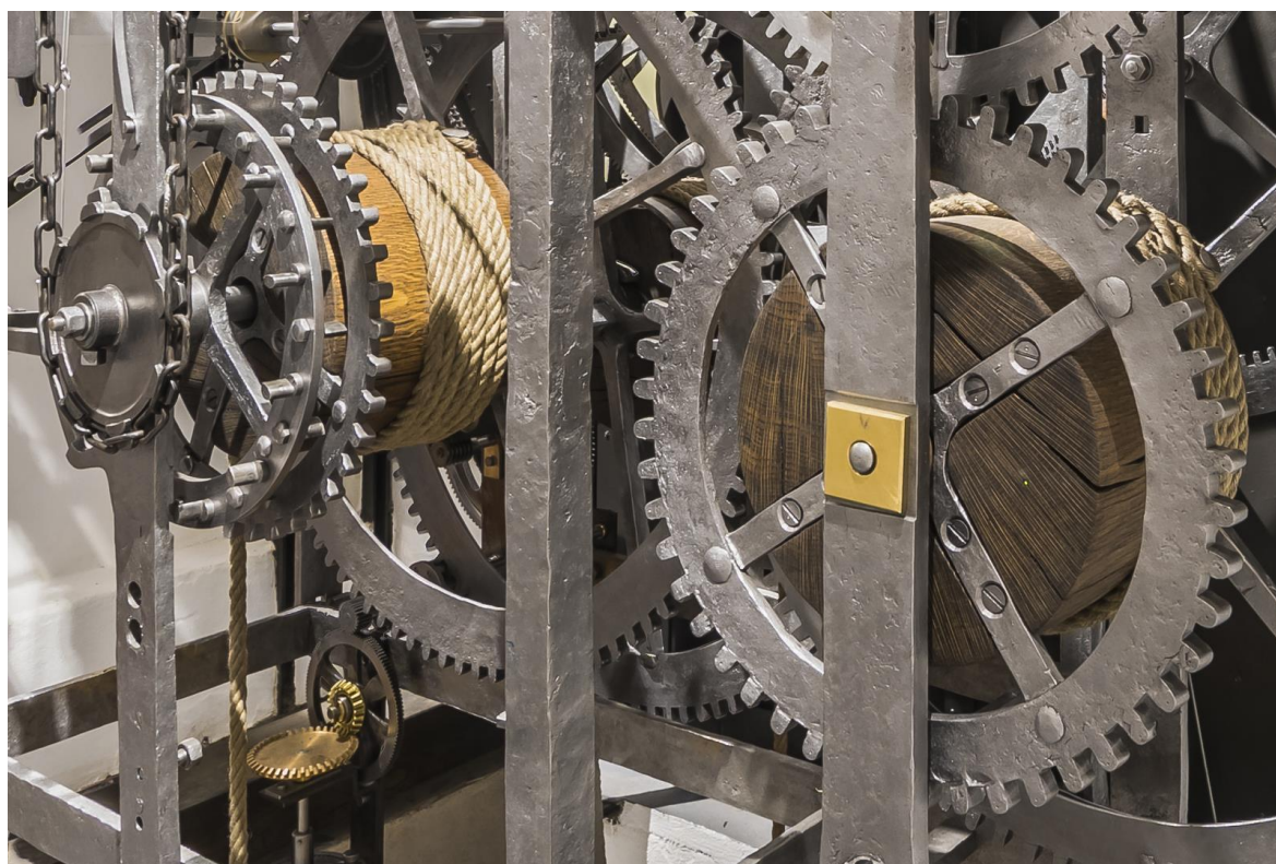
Natahovací ozubená kola osazená zpět do stroje orloje na rekonstruované lanové bubny
