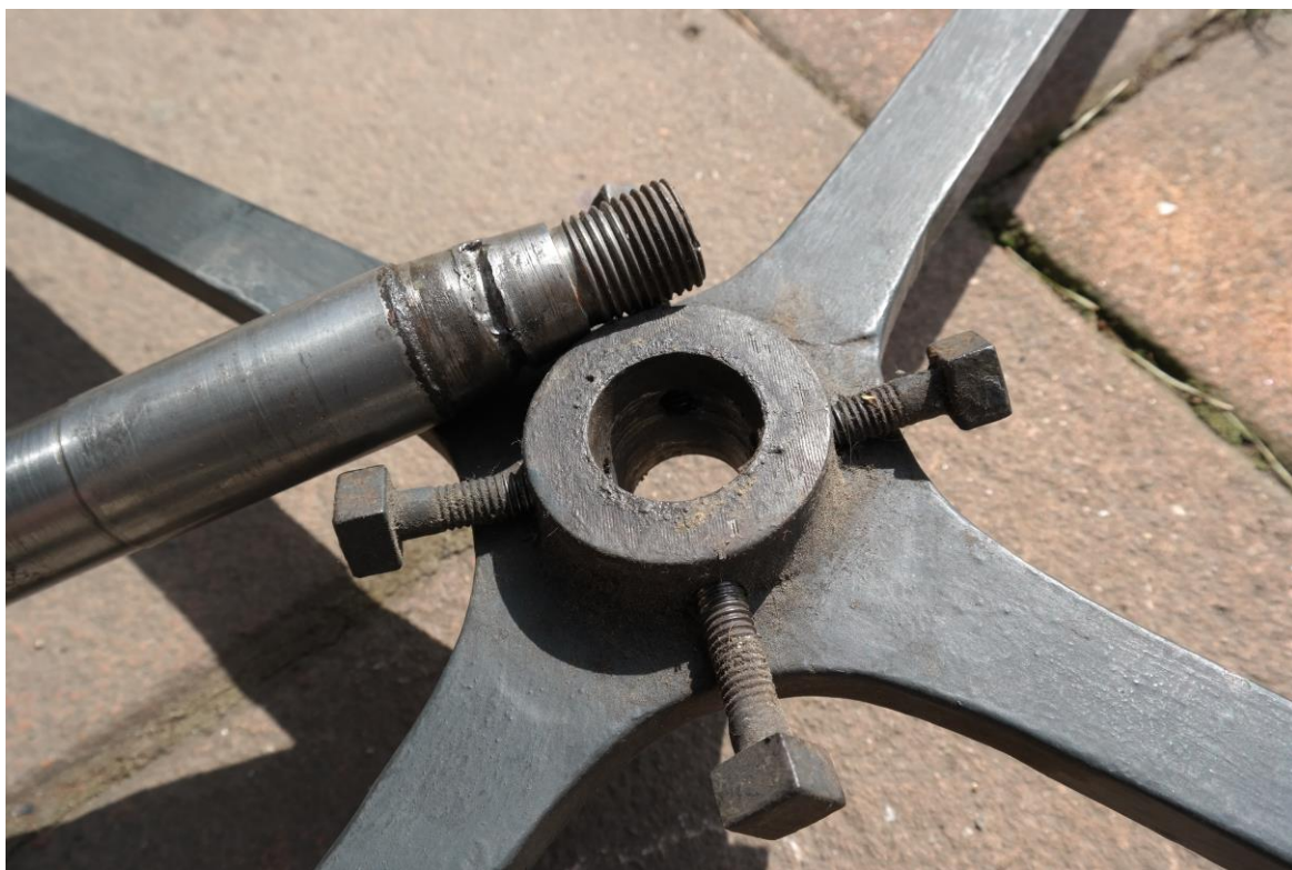
Poškozený konus hřídele ekliptiky
