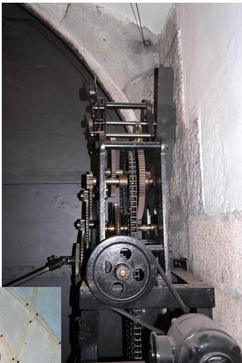
Stroj otáčející vačkou čtyřiadvacetníku
