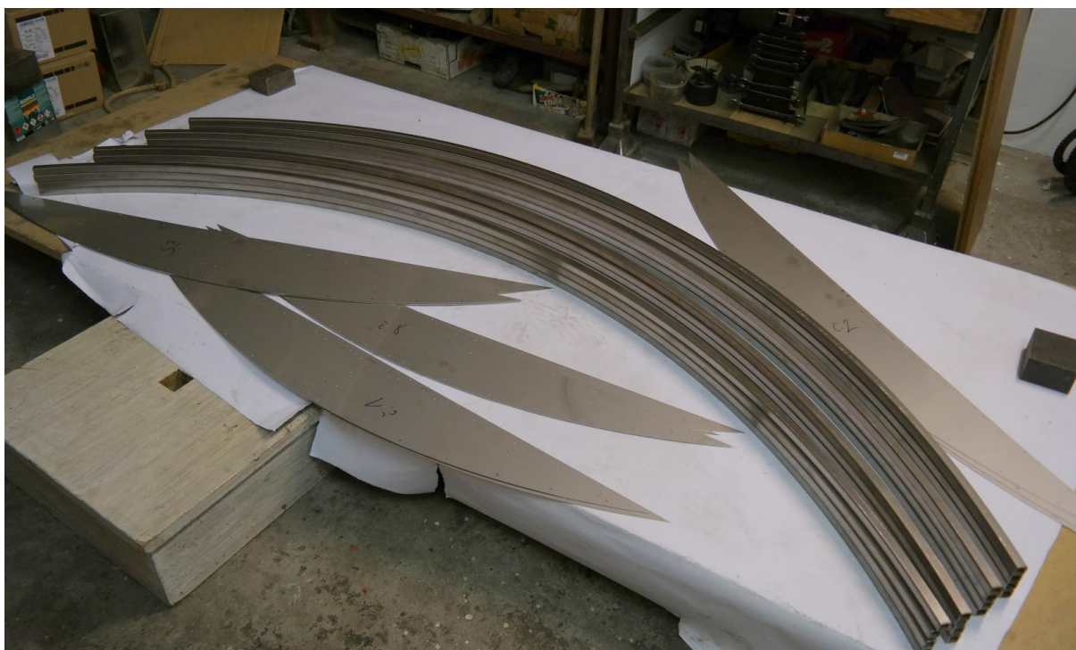
části potahu ciferníků zhotovené z nerezového plechu Dole okrajové díly rámu ze zakroužených nerezových jeklů
