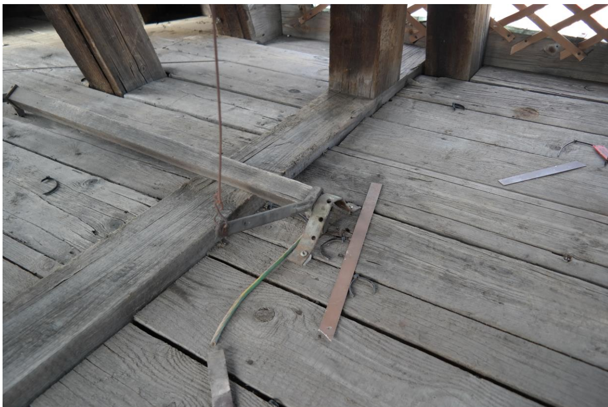
Převody tahové síly k paličkovým strojům před restaurováním a po zrestaurování
