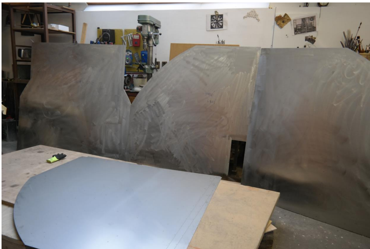
části potahu ciferníků zhotovené z nerezového plechu Dole okrajové díly rámu ze zakroužených nerezových jeklů
