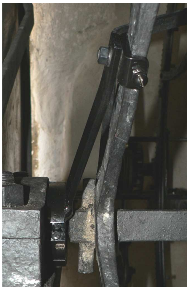
Detail nového spojení hřídele kalendářní desky s ozubeným kolem.
