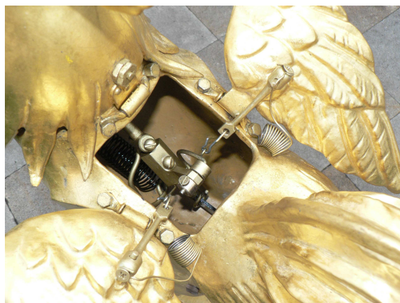
Práce na úpravě kohouta a zhotovení strojku. Vnitřní mechanismus kohouta po úpravě.
