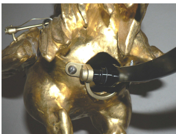
Nové uložení čepu ovládací páky kohouta dovolující zvětšení pohybu křídel a hlavy bez nutnosti rozšiřování otvoru, kterým páka prochází.
