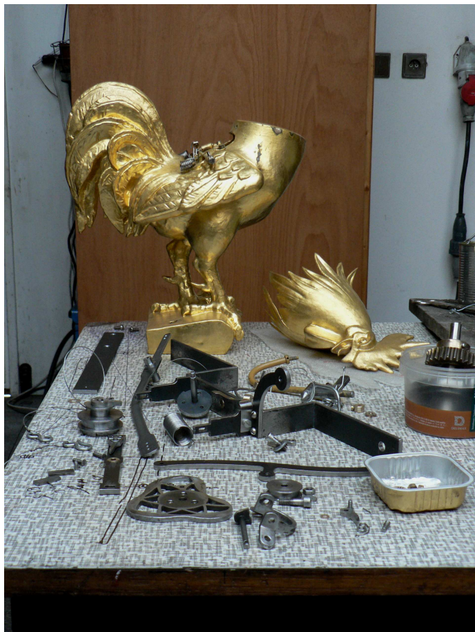
Práce na úpravě kohouta a zhotovení strojku. Vnitřní mechanismus kohouta po úpravě.
