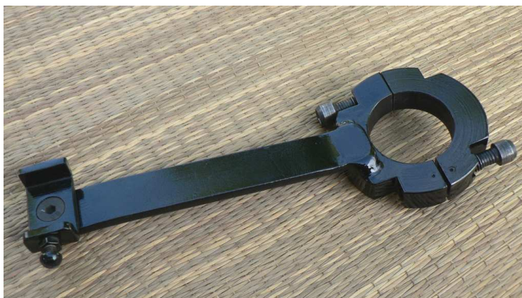
Nově zhotovená spojka hřídele kalendářní desky s hřídelí ozubeného kola
