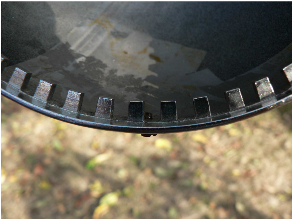
Jeden ze šroubků vyčnívající mezi zuby šnekového kola v dráze šneku
